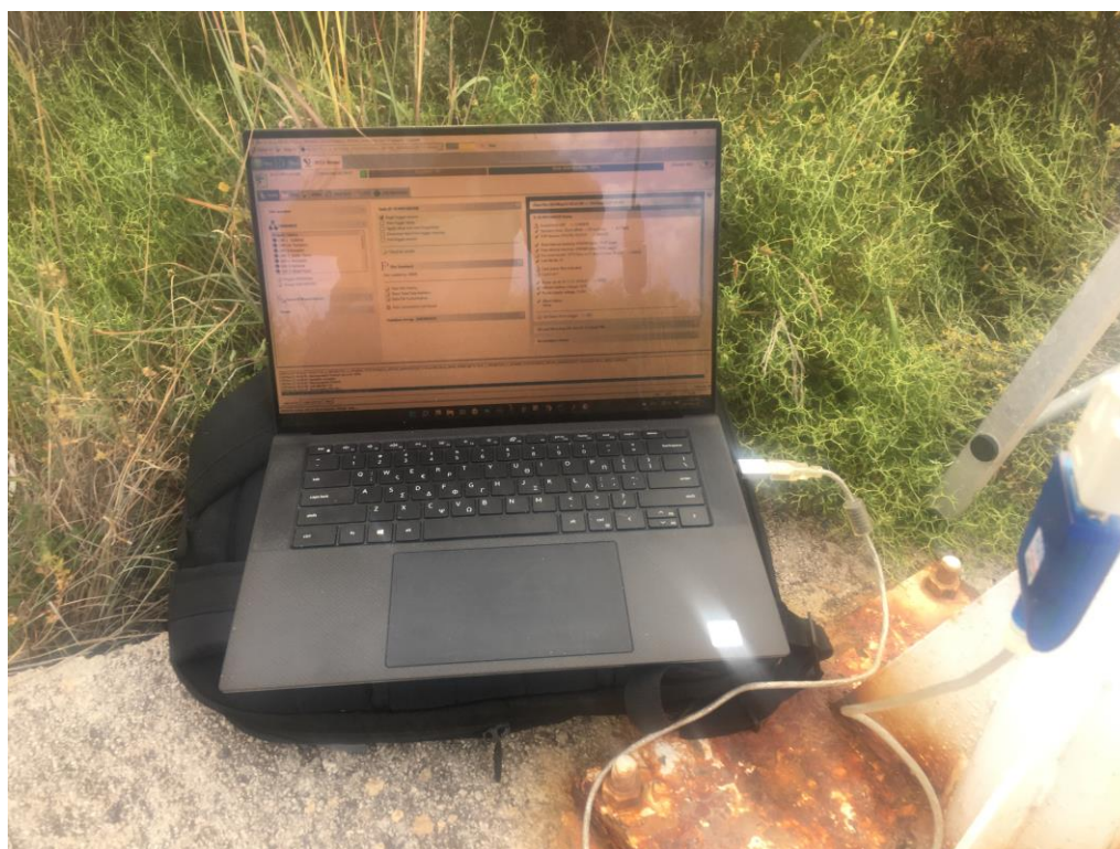
Εικόνα 1.2-5: Απο τις τεχνικές εργασίες στον σταθμό ΖΚΤ-3 στις 30/5/2022 (έλεγχος λειτουργίας modem και setup επικοινωνιών μέσω του φορητού laptop).
